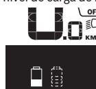
Si en una eBike provista de dos baterías se cargan ambas en la bicicleta, en la pantalla aparecerá el progreso de carga de las dos baterías (en la ilustración se está cargando la batería izquierda). Puede de saber cuál de las dos se está cargando en cada momento observando el indicador intermitente de las baterías.
