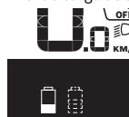
Se numa eBike com duas baterias colocadas forem carregadas ambas as baterias na bicicleta, então no mostrador é exibido o progresso de carregamento de ambas as baterias (na imagem está a ser carregada de momento a bateria esquerda). Qual das baterias está a ser carregada é reconhecível na indicação a piscar na bateria.
